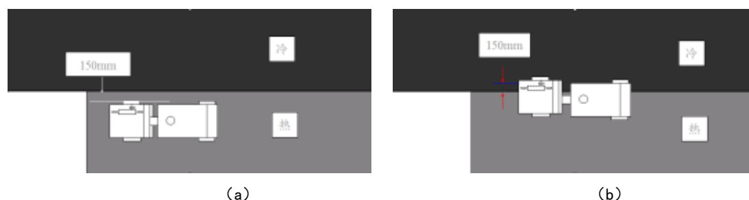
图 1 纵向接缝压实次序
